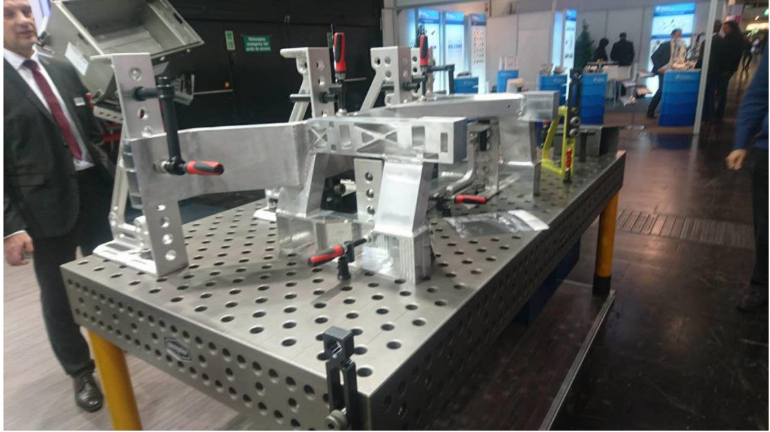
焊接夹具产品的实拍图，请注意其表面的等离子渗氮处理，该项技术可以有效延长焊接平台的使用寿命
